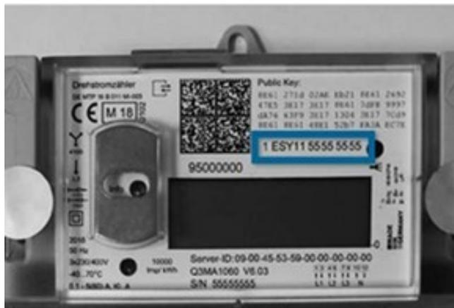
Die moderne Messeinrichtung kann mit einem Kommunikationsmodul verbunden werden, und so zu einem intelligenten Messsystem ausgebaut werden.
